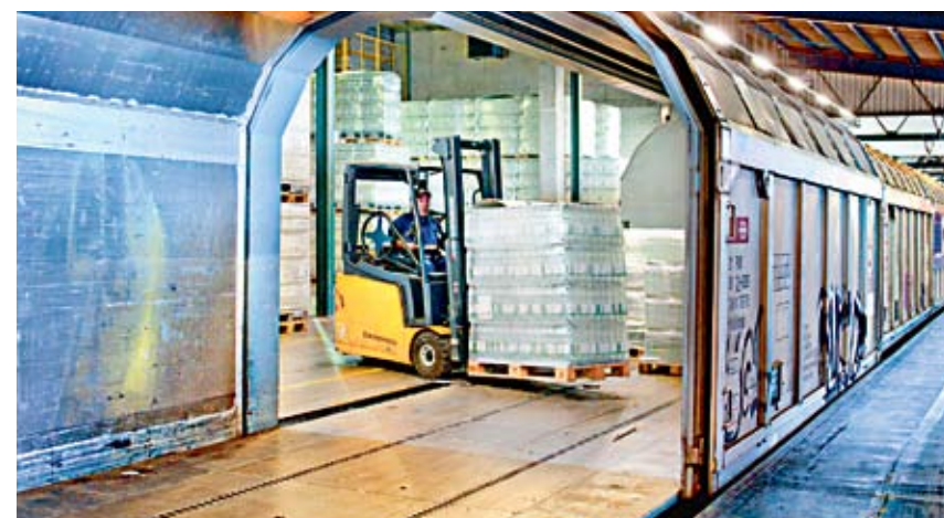
Les trains entrent directement dans la halle de stockage où des transpalettes chargent les wagons.
