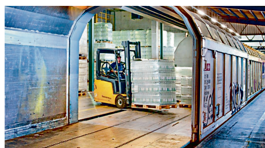
Die Güterzüge können direkt in die Aproz-Verladehalle einfahren, wo sie von Gabelstaplern mit Paletten voll Flaschen beladen werden.
